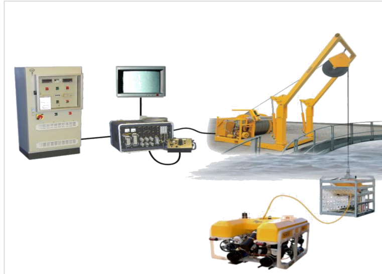
图 1 水下检测机器人系统组成示意图
