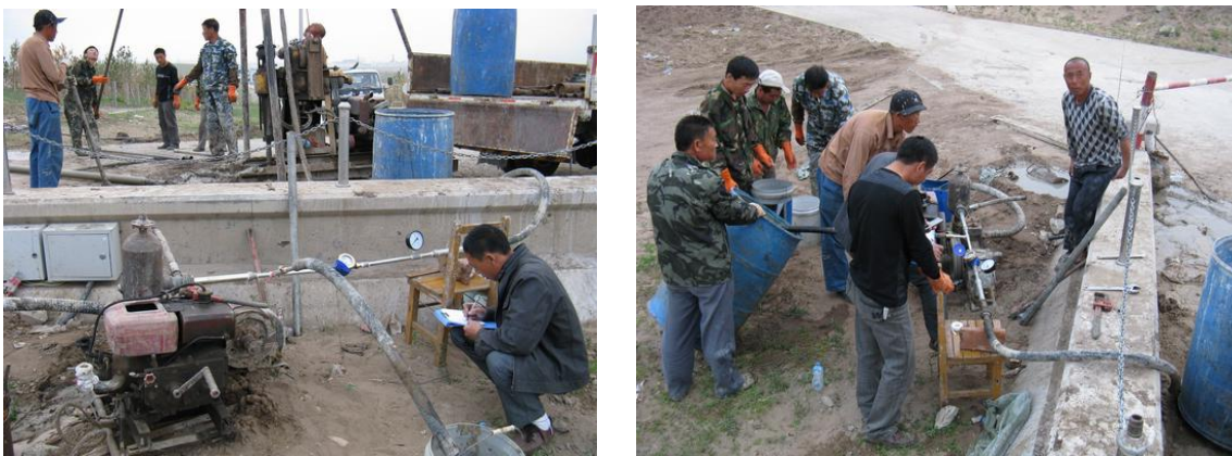
图 4 钻孔压水试验
