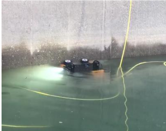
图 2 吸附爬行工作模式 Fig.2 Adsorption crawling mode
