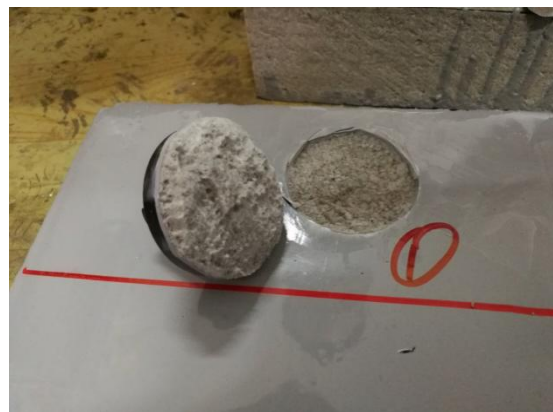
照片 6 防冰拔层与基层拉拔破坏效果
