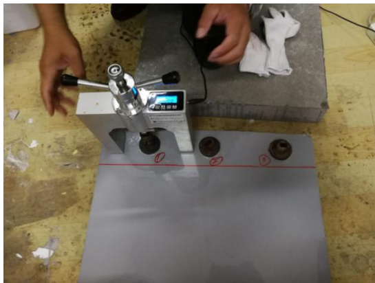
照片 5 拉拔检测粘接情况
