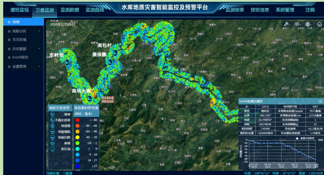
图 13 三板溪水电站库区地质灾害 InSAR 监测成果
