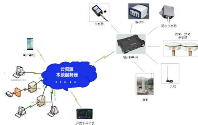
图1 土石方开挖施工质量控制物联网系统
