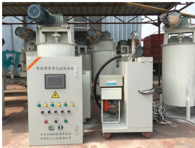
图7 集成式水泥智能灌浆单元机
