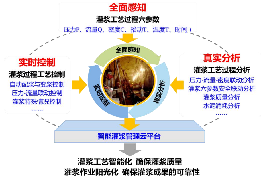
图2 数据驱动的智能建造管理闭环控制理论模型及其应用实例
