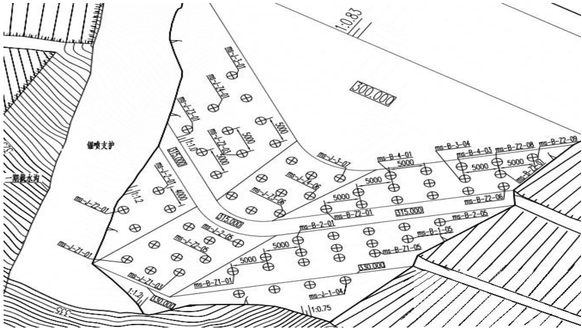
图7 座滑体高程330m300m边坡锚索布置平面图
