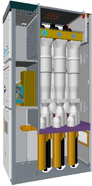
图 3 35KV 固体柜的内部结构剖视图
