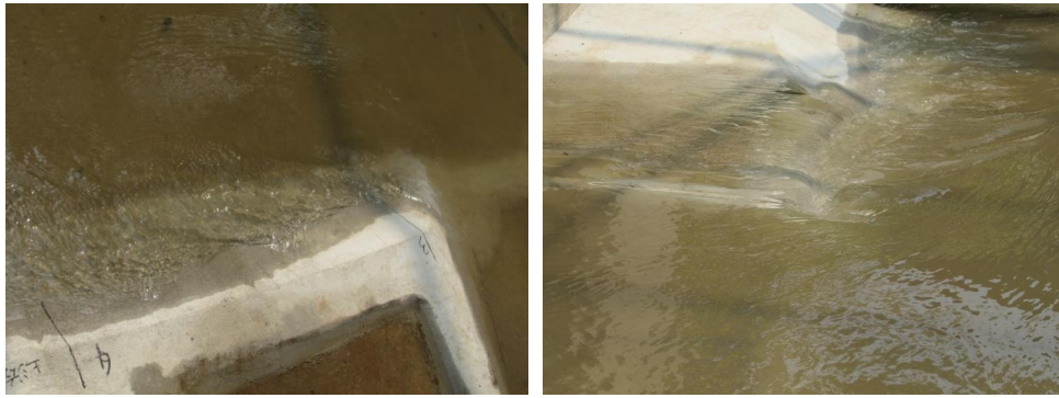
(1) 流量 5180\text{m}^3/\text{s} 条件下阶梯式进口流态图 (2) 流量 12100\text{m}^3/\text{s} 条件下阶梯式进口流态图
