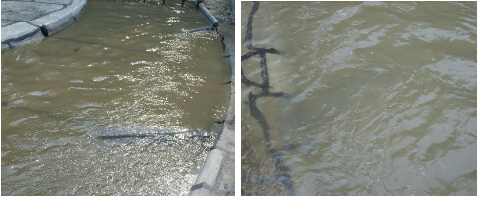
(3) 流量 5180m 3 /s 下潜坝区域流态图
